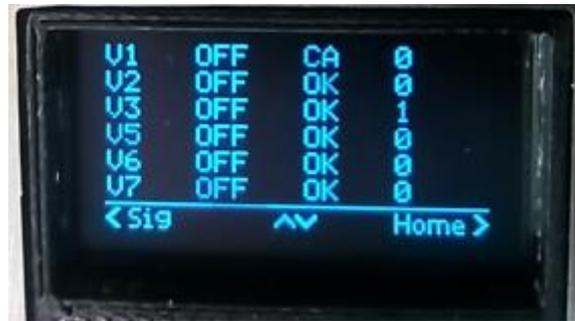
Monitor de corrientes: Falla Circuito Abierto V1
