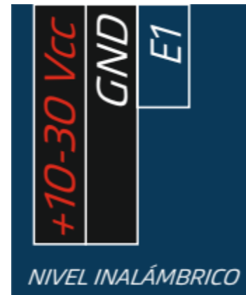
Figura 2. Imagen de la bornera de entradas de la unidad central
